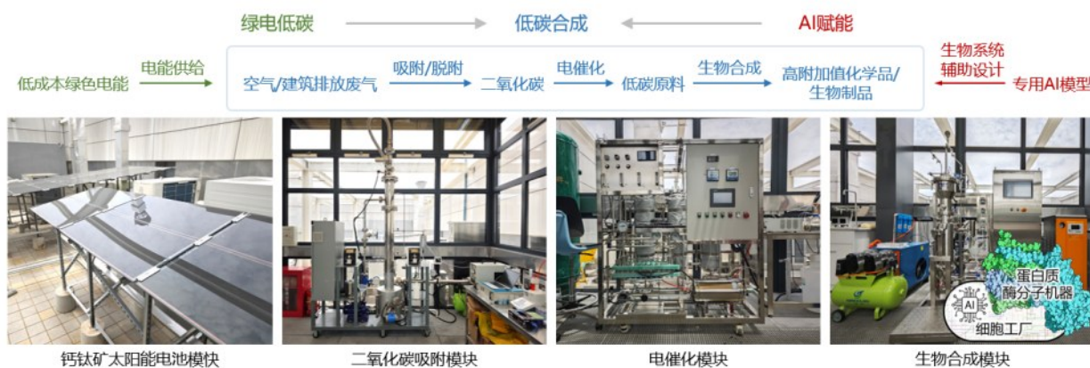
图3 从空气/建筑物排放废气中捕捉二氧化碳、电催化二氧化碳还原与生物合成及应用耦合一体化中试装置（西湖大学）。（该装置包含钙钛矿太阳能电池模块、二氧化碳吸附模块、电催化模块以及生物合成模块。其中，“绿电低碳”利用绿电及化学催化将二氧化碳转化为甲酸、甲醇、乙酸、乙醇等基础原料，实现碳资源的再生与循环利用；“低碳合成”依托高稳定性催化剂和基因编辑技术构建高效细胞工厂，将上述低碳基原料转化为高附加值化学品和其它物质；“AI赋能”是借助人工智能蛋白质大语言模型与高通量自动化实验平台，实现酶元件设计、代谢通路优化及合成速率提升的智能化，加速城市代谢与生物制造产业的落地）
