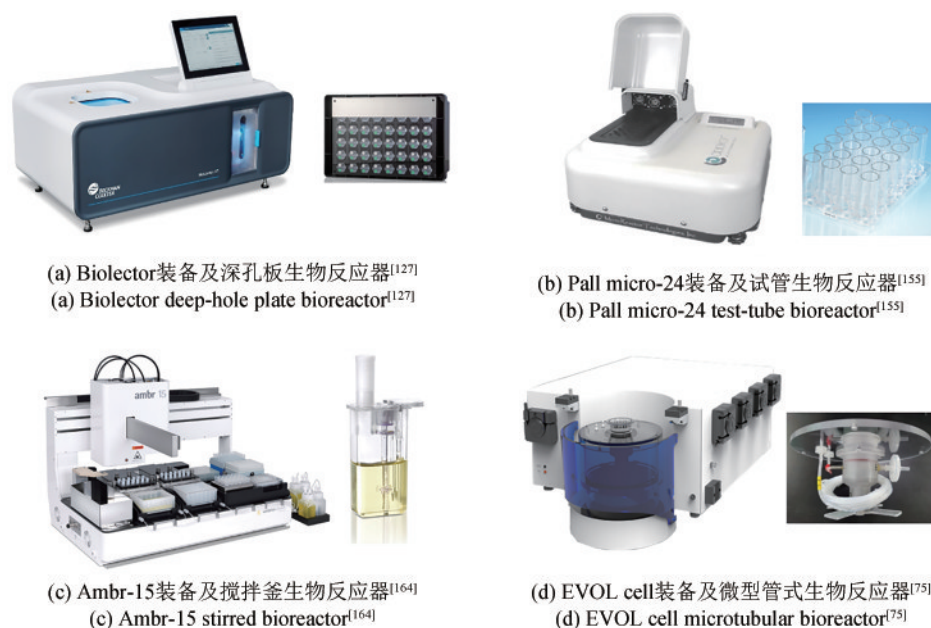
图6 不同类型的毫升级微型反应器及其装备
