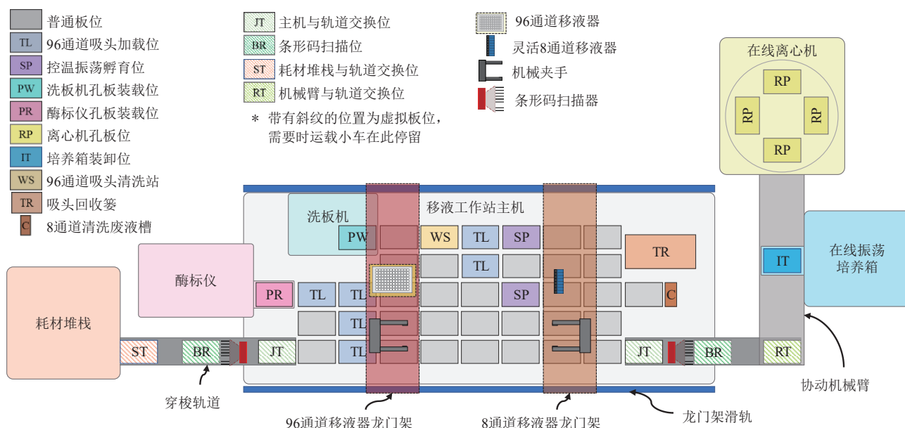
图2 小型集成化移液工作站系统实例
